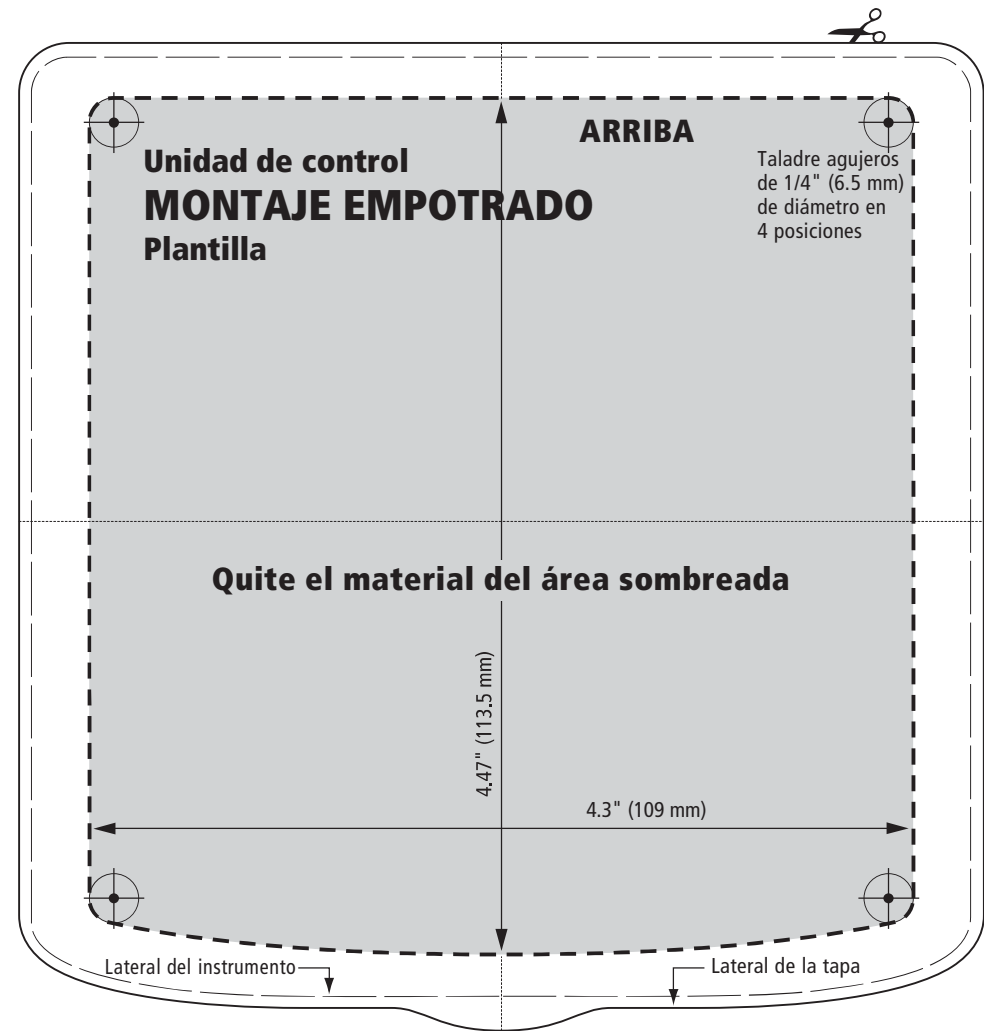
Plantilla de MONTAJE EMPOTRADO para Instrumentos ST60+
